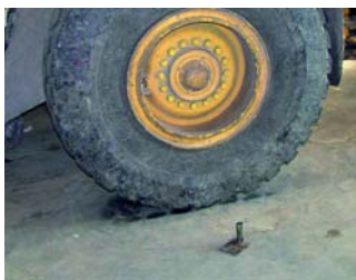
Ein Metallteil verursachte einen Schaden am Lader der ABL (Abfallbehandlung Lavant)
